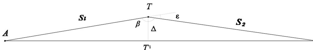
Описать последовательность действий для установки инструмента в створ (в точку  $T_1$ . (для тригонометрических вычислений использовать  $\rho=206265''$ )
